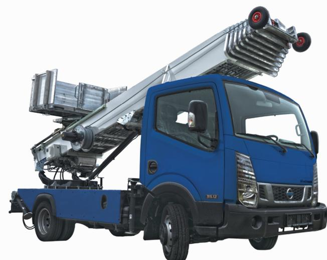
Montés sur différents types de véhicules utilitaires ne dépassant pas 3,5 tonnes.
