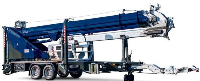
Une gamme de grues en aluminium montée sur châssis remorque à deux essieux, autotracté.
